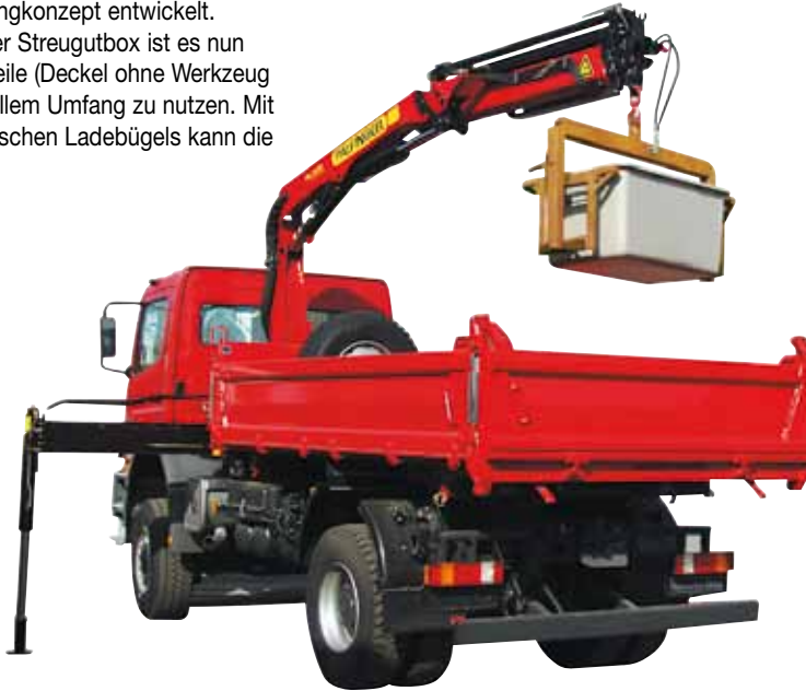
Einfahren des Ladebügels von der Seite nach dem Entfernen des abnehmbaren Deckels (Beispiel mit Streugutbox 700 l)
