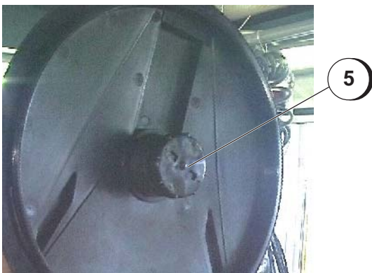
Bild 5.4.4: BWS 130: Schwimmer als Schwallschutz (Ansicht Deckelunterseite)
