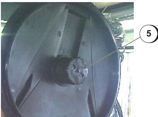
Image 5.4.4 BWS 130: Flotteur servant de protection antidébordement (vue: dessous du couvercle)
