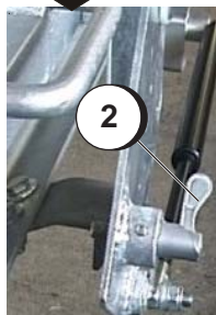
Image 5.5.2e: Lever remis dans la pos. d'arrêt.
