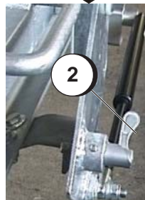
Bild 5.5.2e: Schwenkhebel zurück gedreht in Rastpos.
