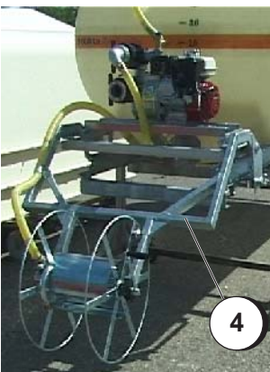
Bild 5.5.2b: BWS 500 auf „Lkw“ - Schlauchhaspel unten
