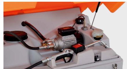
Elektrozahnradpumpe 230V, 9l/min, 12 bar und digitaler Handdurchlaufzähler für Schmierstoffe (nicht eichfähig*)
