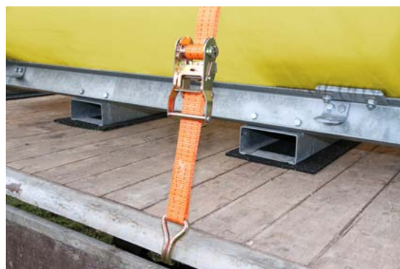
Ladungssicherung mit Antirutschmatte und Zurrgurten (Niederzurren) am Beispiel eines Mobilien Bewässerungssystems 2.000 Liter
