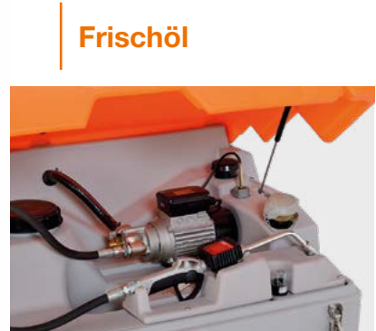
Elektrozahnpumpe 230 V, 9l/min, 12 bar und digitaler Handdurchlaufzähler für Schmierstoffe (nicht eichfähig*)
