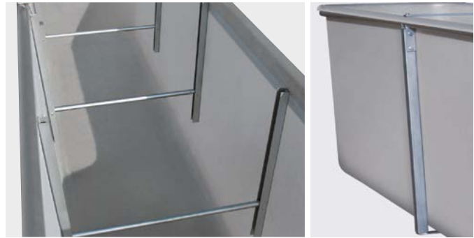
Großbehälter: Innenstreben aus Edelstahl für den Einbau ins Erdreich, Außenstreben feuerverzinkt für die oberirdische Aufstellung
