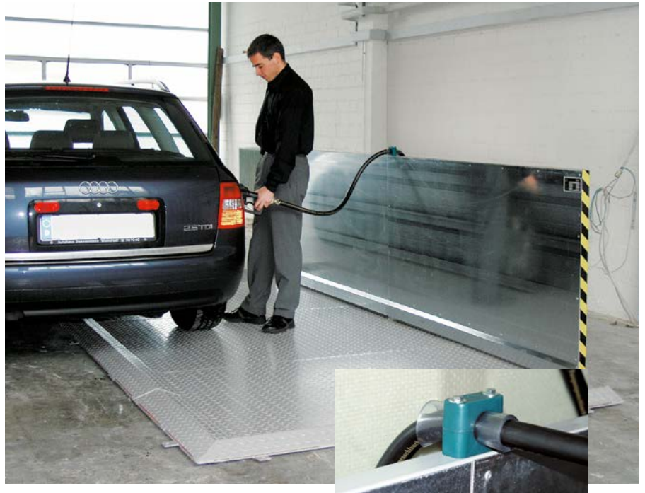
Sichere Füllschlauch-Halterung mit Knickschutz und Längenbegrenzung.
