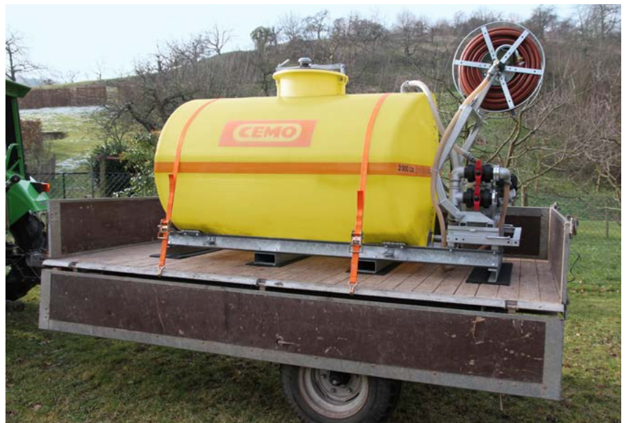
Ladungssicherung mit Antirutschmatte und Zurrgurten (Niederzurren) am Beispiel eines Mobilien Bewässerungssystems 2.000 Liter
