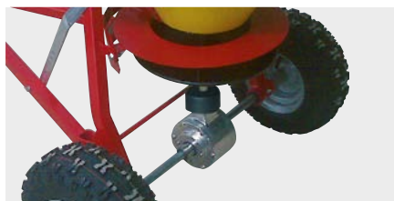
robustes Getriebe mit Aluminiumgehäuse
