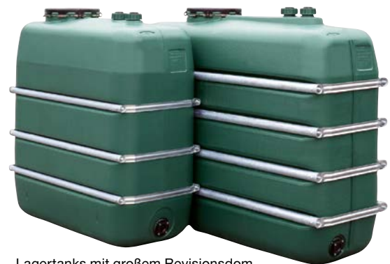
Lagertanks mit großem Revisionsdom, 2 Anschlüssen 2" und Flanschanschluss (1100, 1500 und 2000 l mit Bandagen)
